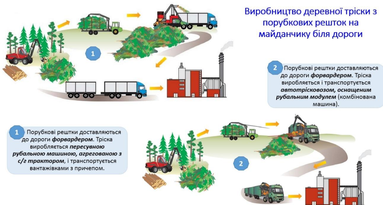
Рис. 7.1. Логістика виробництва деревної тріски з порубкових решток на майданчику біля дороги.
