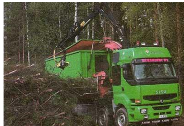
Виробництво деревної тріски з порубкових решток автотрісковозом, оснащеним рубальним модулем (комбінована машина)
