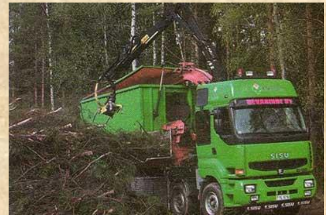
Виробництво тріски з порубкових решток автотрісковозом, оснащеним рубальним модулем (комбінована машина)
