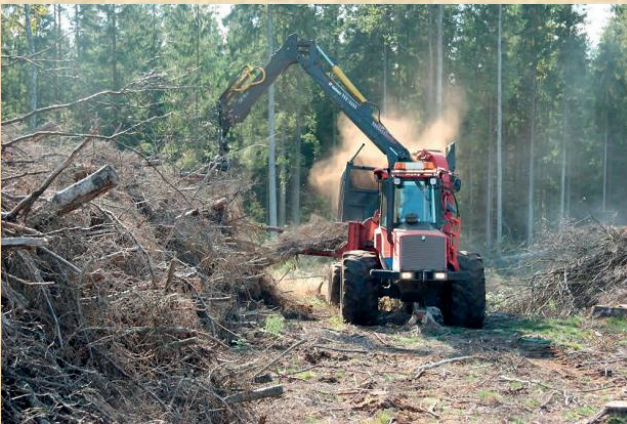
Виробництво тріски з порубкових решток рубальною машиною, агрегованою з с/г трактором
